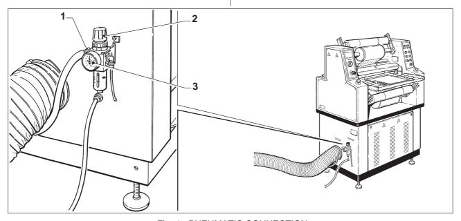
Fig. 4 - PNEUMATIC CONNECTION
