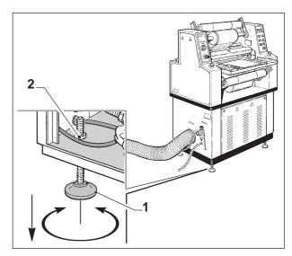
Fig. 3 - ML 360/N HEIGHT ADJUSTMENT
